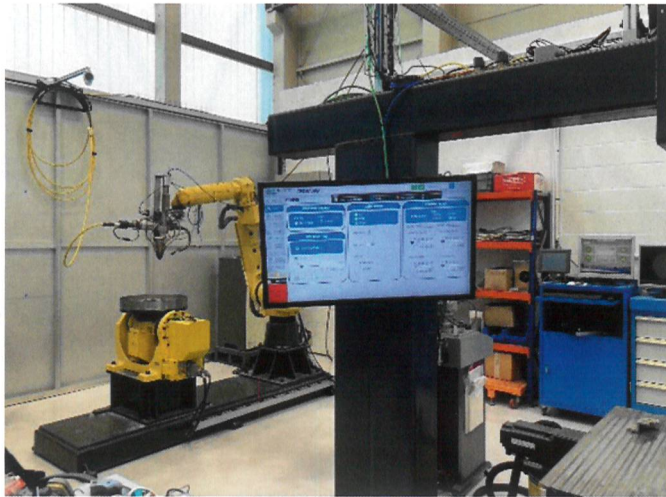
Figura 1 – Célula de fabricación DED-LB/M en las instalaciones de LORTEK: (a) vista del brazo robot, posicionador y la HMI, (b) vista del brazo robot, posicionador y los alimentadores duales de polvo
