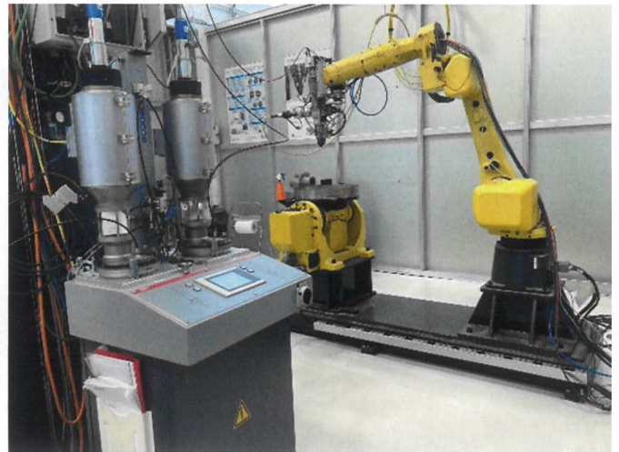
Figura 1 – Célula de fabricación DED-LB/M en las instalaciones de LORTEK: (a) vista del brazo robot, posicionador y la HMI, (b) vista del brazo robot, posicionador y los alimentadores duales de polvo
